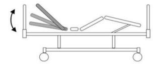
Спинная секция ложа может быть поднята до 87° при помощи рукоятки регулировки спинной секции кровати, которая находится под ножной спинкой.
